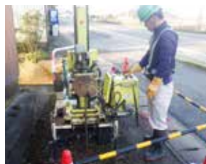
スウェーデン式サウンディング→ スクリューウェイト貫入試験 (JIS A 1221)
